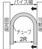
チューブを左図状に固定し、可動端を徐々に固定端に近づけ、折れの生じないR。
